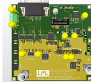
Electronique diode laser Résolution 1uA DAC 20bits
