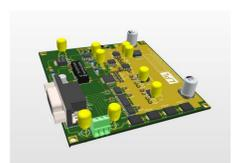
Montage générateur de courant, DAC 20bits
